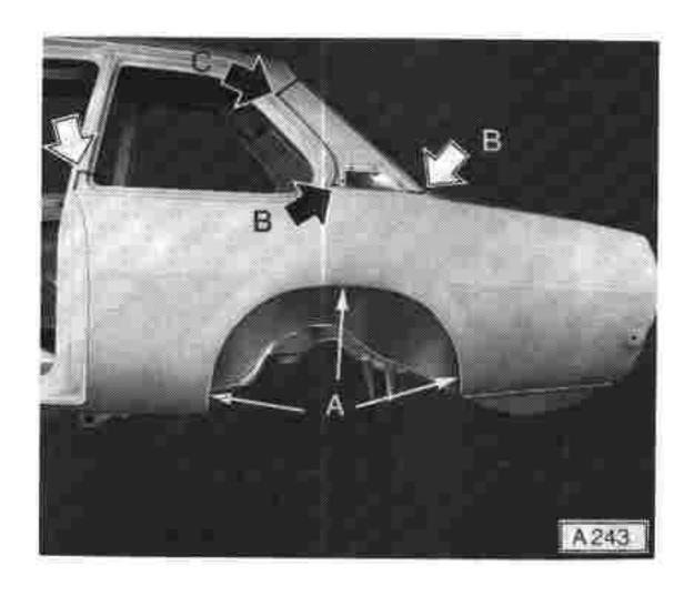
Bei Manta-B-Fahrzeugen äußere Prägekante »D« durchschleifen. Restflansche abrollen. Bei Schäden oberhalb der Verbindungsstelle »E« Dachverlängerung an der Original-Verbindungsstelle »F« trennen.
