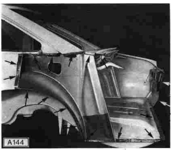
Rückwand-Neuteil in Karosserie einpassen. Dabei das Bohrungsmittenmaß »D« 702 ± 1 mm einhalten. Auf Anlageflächen der Punktschweißflansche Punktschweißfarbe auftragen. Neuteil an Karosserie festspannen und mit den angegebenen Elektrodenarmen zangenpunkten. Unteres Ende der Rückwand-Verstärkung stumpfschweißen.
