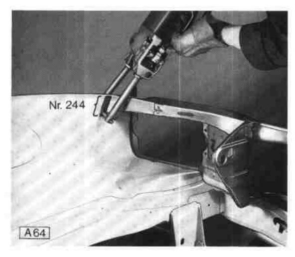
Schweißungen an Längsträgerabdeckung (Knotenblech) und Kühlerstütze unten.
