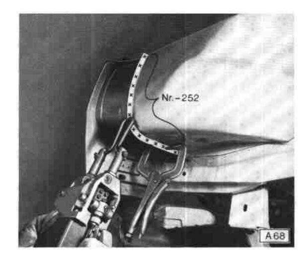
Schweißungen an Luftleitblech seitlich, Knotenblech auf Längsträgerabdeckung und Kühlerstütze.
