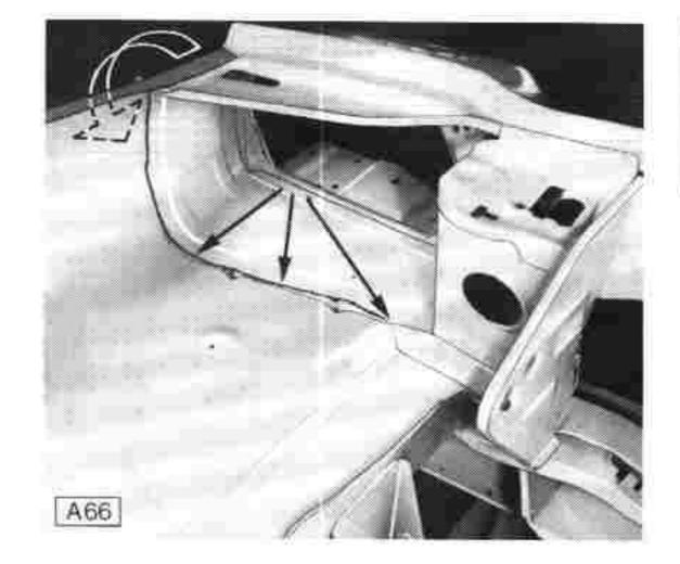
Strebe seitlich, Knotenblech auf Längsträgerabdeckung und Kühlerstütze von Original-Punktschweißstellen abbohren.
