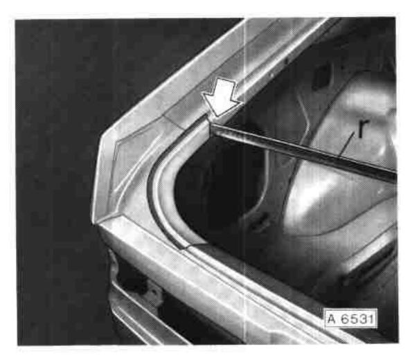
s = Diagonale Rahmen Rückwandklappe oben zu
