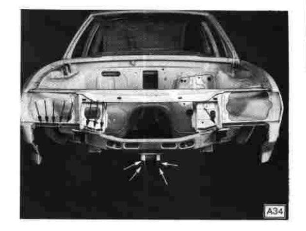
Punktschweißflansche an Karosserie und Neuteil blankschleifen. Punktschweißfarbe auftragen. Neuteil einpassen und an Karosserie festspannen.
