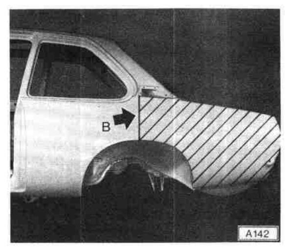
Rückwand unten, beginnend an der Schadensseite, in Richtung gegenüberliegende Seitenwand trennen. Dabei soll die Trennung nur bis zur Stelle »C« (mit Heckleuchteneinsatz) vorgenommen werden. Bei den abschließenden Lackierarbeiten kann dann zwischen Trennlinie und Seitenwand ein einwandfreier Übergang lackiert werden.
