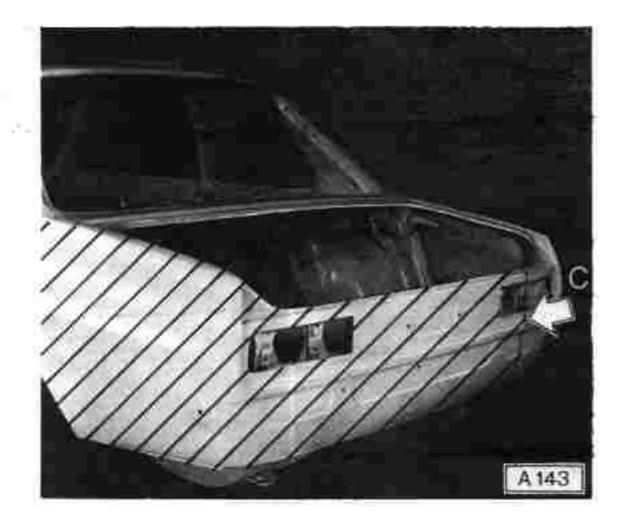
Punktschweißflansche an Karosserie beidseitig blankschleifen. Flansche, wenn nötig, richten.
