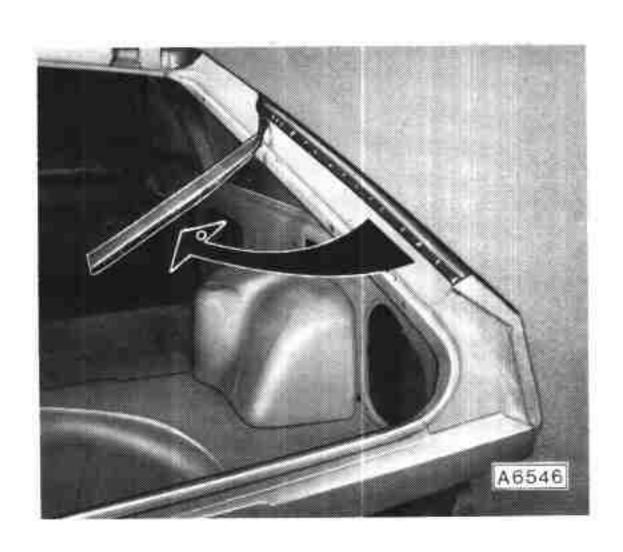
Verbindungsflansche vorbereiten. Neuteil entsprechend den Trennungen einpassen.
