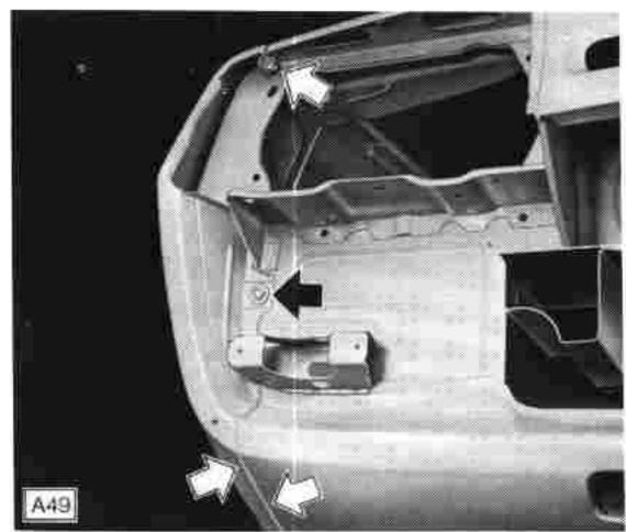
Neuen Kotflügel anpassen. Anschraubflansche an Karosserie mit Abdichtmasse, Katalog-Nr. 15 70 587, auslegen. Kotflügelinnenseite mit Dämpfungsmasse, Katalog-Nr. 15 00 365, ausspritzen.
