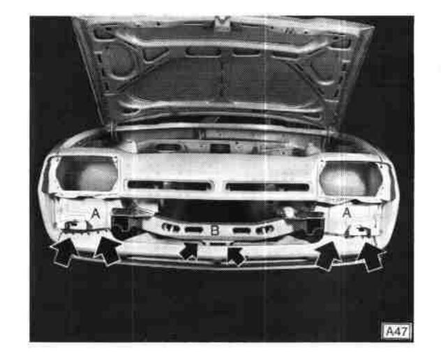
Punktschweißflansche an Karosserie und Neuteil blankschleifen und mit Punktschweißfarbe bestreichen.
