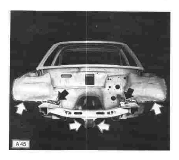
Neuteil einpassen. Beide Kotflügel und Motorhaube befestigen. Motorhaube in Schließstellung bringen. Dabei auf gute Passung zwischen Luftleitblech, Kotflügel und Motorhaube achten. Luftleitblech an beide Radeinbauten anschweißen. Schweißungen am Scheinwerfereinsatz.
