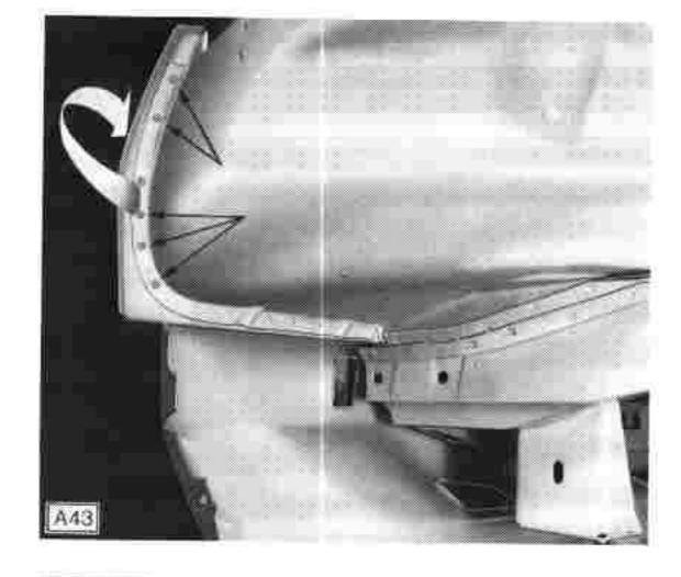
Strebe seitlich, Knotenblech auf Längsträgerabdeckung und Kühlerstütze an Original-Punktschweißstellen abbohren.
