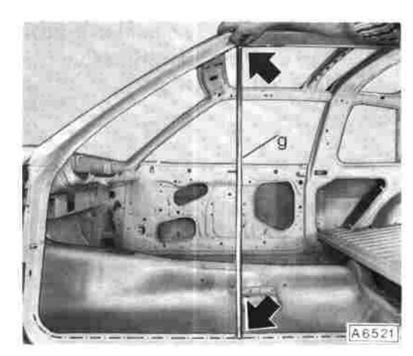
h = Diagonale Türrahmen oben bis Einstieg hinten unten auf dem Grund des Türabdichtflansches.
