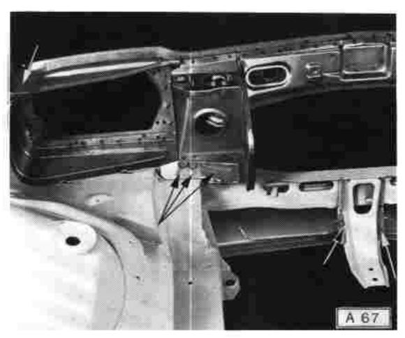
Punktschweißflansche an Karosserie und an Neuteil blankschleifen. Punktschweißfarbe aufbringen.
