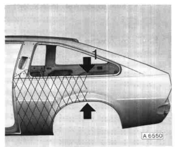
Verbindungsflansche vorbereiten. Neuteil entsprechend der Trennungen über Mitte Radeinbau einpassen.
