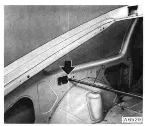
q = Abstand zwischen Bohrungsmitte Stoßdämpferlager - linke Seite gezeigt.
