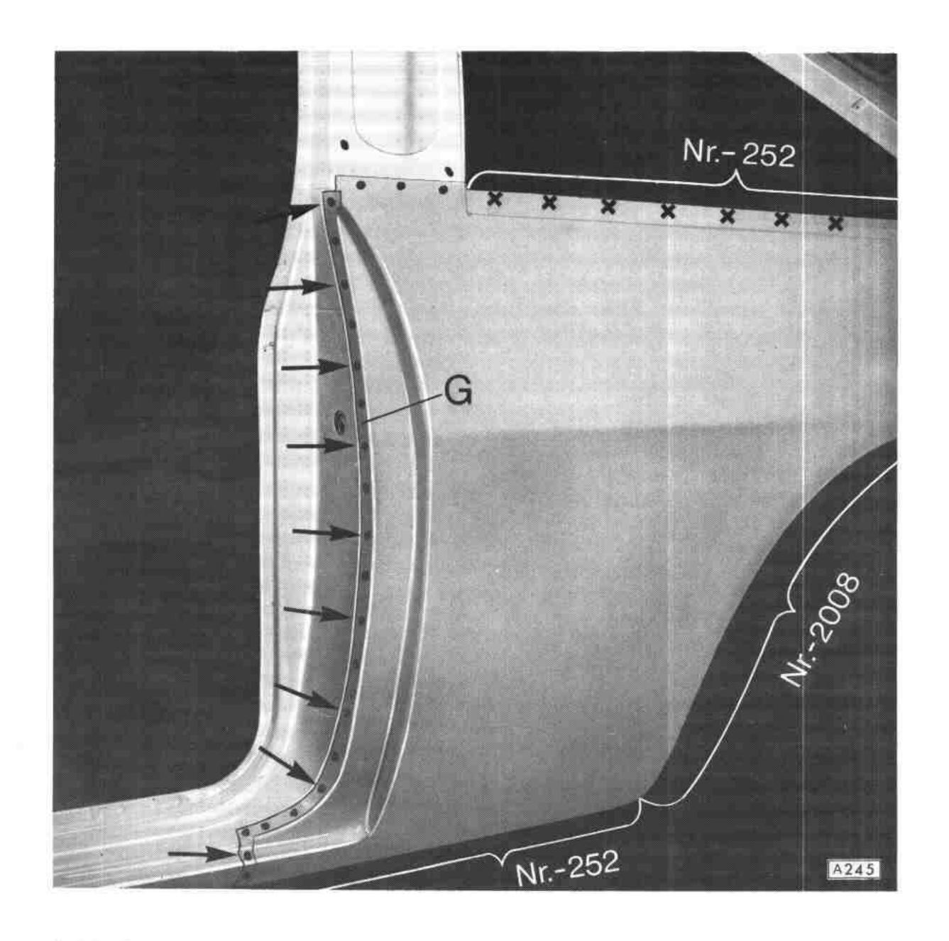
An Verbindungsflansch »G« lochschweißen. Restliche Flansche punktschweißen. Schweißstellen verputzen.
