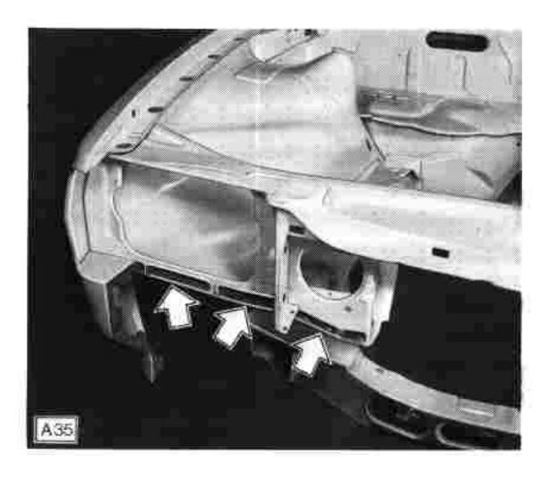
Neuteil im Bereich »A« punktschweißen. An den Stellen »B« hartlöten. An Kühlerstütze lochschweißen. Schweiß- und Lötstellen verputzen. Trennfuge im Bereich »C« mit Ausgußmasse »hell« auslegen.
