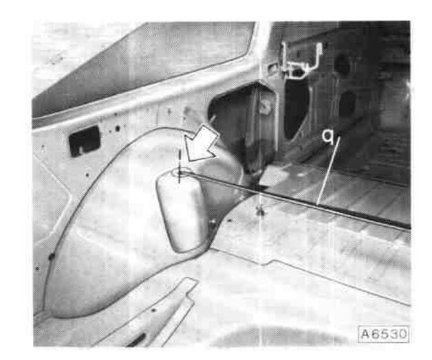
r = Abstand zwischen inneren Seitenwänden an Eckverstärkung zu Rückwand - linke Seite gezeigt.
