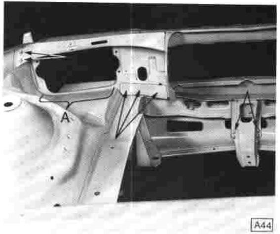
Punktschweißflansche an Karosserie und an Neuteil blankschleifen und mit Punktschweißfarbe bestreichen.
