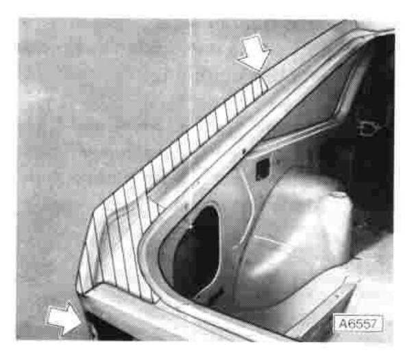
Verbindungsflansche herrichten. Neuteil entsprechend den Trennungen einpassen. Neuteil einschweißen.
