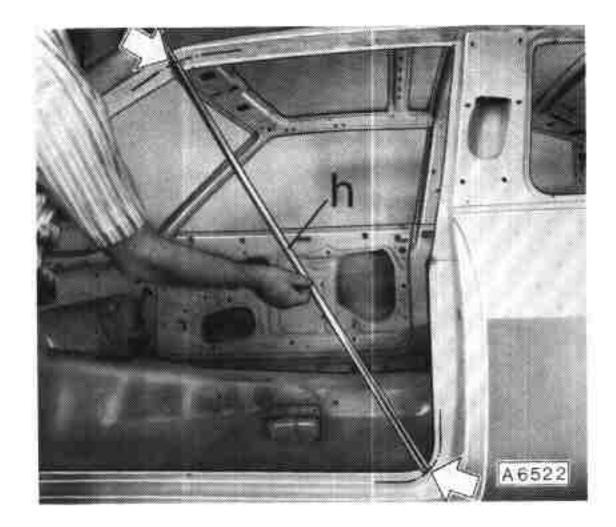
j = Abstand zwischen A- und B-Säulen vorn: Grund des Flansches hinten: Vorderkante des Flansches
