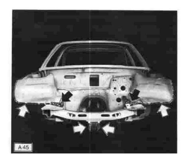
Neuteil einpassen. Beide Kotflügel und Motorhaube befestigen. Motorhaube in Schließstellung bringen. Dabei auf gute Passung zwischen Luftleitblech, Motorhaube und Kotflügel achten. Luftleitblech an beide Radeinbauten anschweißen.
