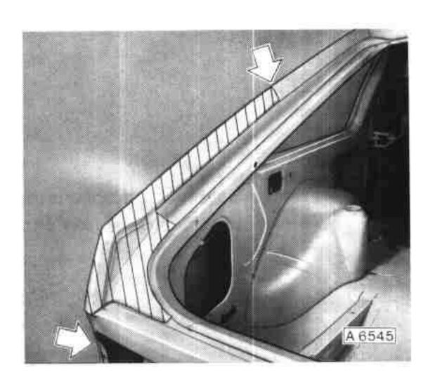
Bild A 6546 zeigt das Entfernen der übergesetzten Seitenwand an den Punktschweißstellen des Rückwandklappenrahmens (rechte Wagenseite).
