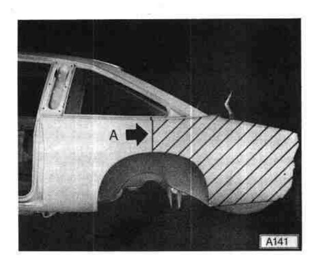
Bei Ascona-B-Fahrzeugen an der Stelle »B« und an den Original-Verbindungsstellen trennen.
