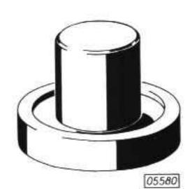
S-1211 Hinterachswellenkugellager, Haltering- und Wasserablenkblech -Ab- und Aufpreßwerkzeug
