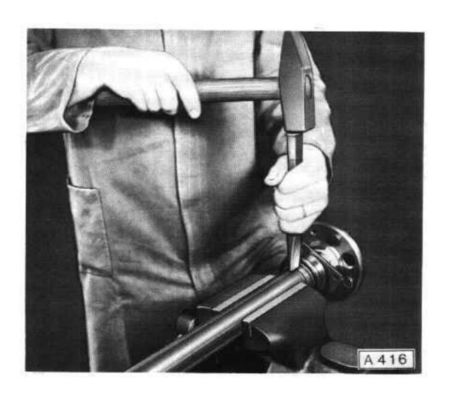
Bei Fahrzeugen mit 12 S- und 16 N-Motoren: Haltering und Kugellager unter Presse mit Abdrückplatte S-1211 abpressen.
