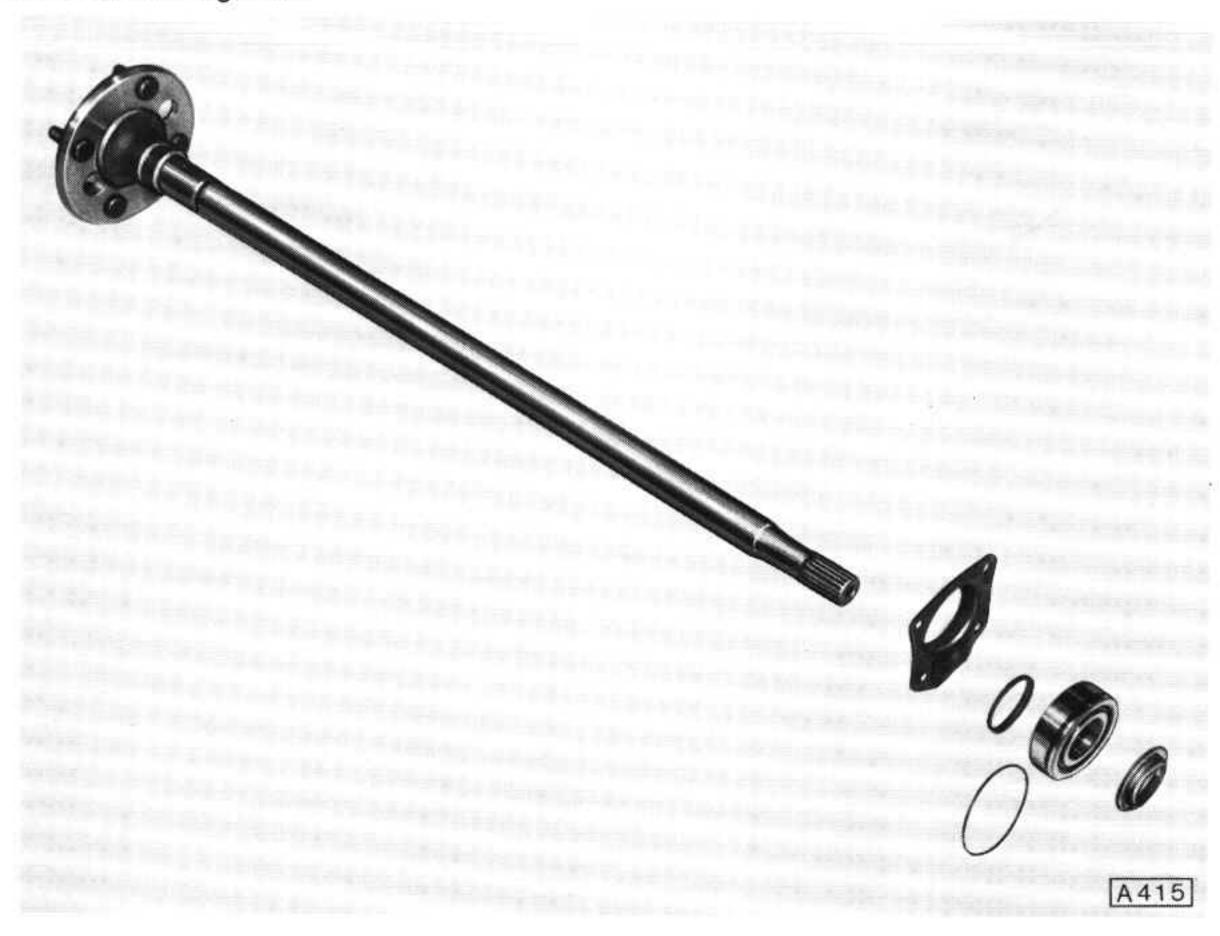
Lagerteile einer Hinterachswelle bei Fahrzeugen mit 12 S- und 16 N-Motoren. Fahrzeuge mit 16 S-, 19 S- und 19 E-Motoren haben die gleichen Lagerteile, jedoch größer dimensioniert.
