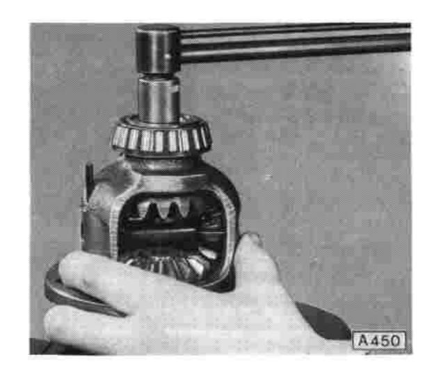
Spiralstift für Ausgleichachse bis Anschlag einschlagen.
