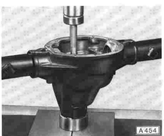
Kegelkäfig von Antriebskegelrad abpressen. Bei Fahrzeugen mit 12 S-, 16 N-Motoren: Werkzeug S-1205, 16 S-, 19 S-, 19 E-Motoren: Werkzeug SW-56 verwenden.
