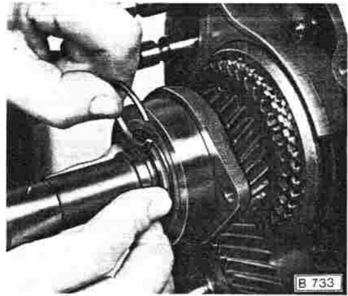
Schließring auf Hauptwelle, über den Sicherungsring, aufsetzen.
