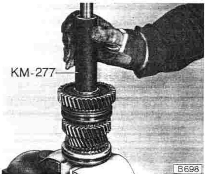
Lagerinnenring auf ca. 80° C erwärmen und bis zur Anlage an der Distanzhülse auf Hauptwelle montieren.
