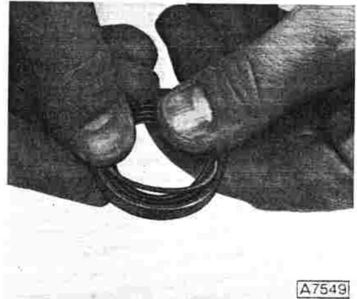
Dichtring mit KM-411 in Ausrücklager-Führungshülse einpressen.
