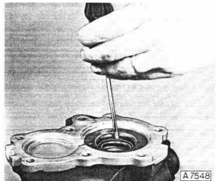
Dichtring in Ausrücklager-Führungshülse einbauen.
